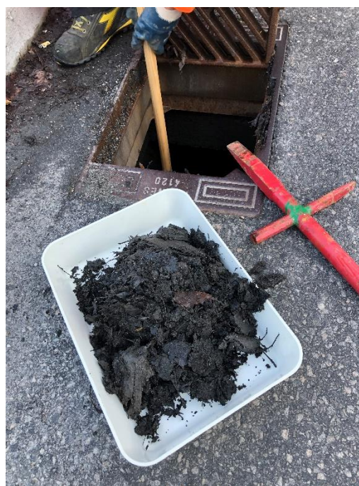
Figur 3.3. Til venstre: Kjøretøyet i ferd med å fjerne overvann fra et sandfang. Til høyre: Sedimentprøver tas med spade fra en sandfangskum. Foto: NORCE, Einar Bye-Ingebrigtsen.
